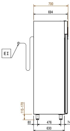
EI = Conexión eléctrica (energía)
